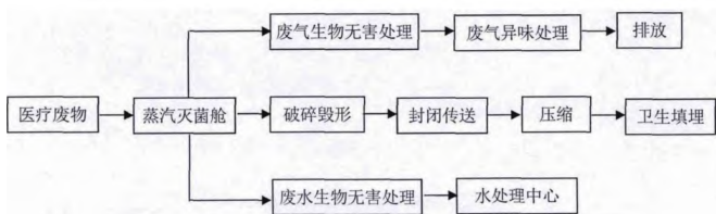
图1 高温蒸汽医疗废物处理框架
